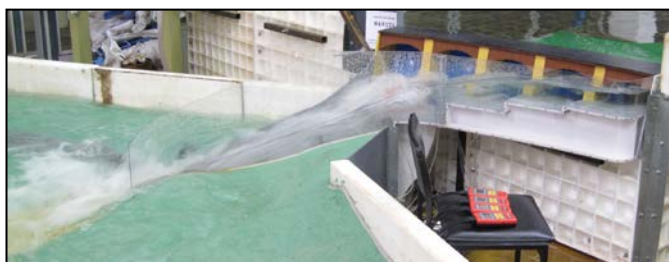
Obr. 3: Foto z měření hladin, tlaků a pulzací ve skluzu na VD Harcov
