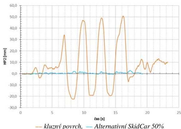
Obrázek 5 Průběh stáčívé rychlosti \omega pro kluzný povrch a Alternativní SkidCar (autor)
